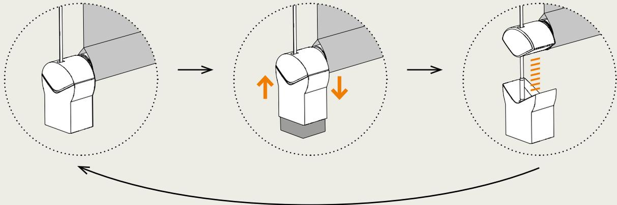
Magnetic Lock System® è l'aggancio magnetico nato dall'esigenza di consentire il continuo tensionamento del telo della tenda anche in presenza di brezze sostenute. Brevetto Europeo esclusivo Pratic. Modelli depositati.
